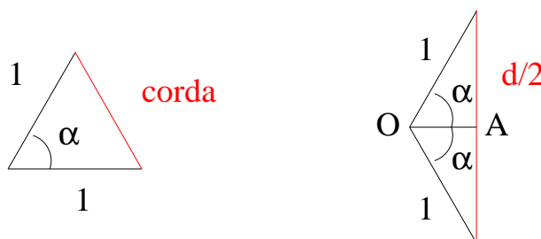
Figura 5.2: Funções trigonométricas do ângulo \alpha : \sin \alpha = d/2 , \cos \alpha = \overline{OA} . Pelo teorema de Pitágoras vem que \sin^2 \alpha + \cos^2 \alpha = 1 .
