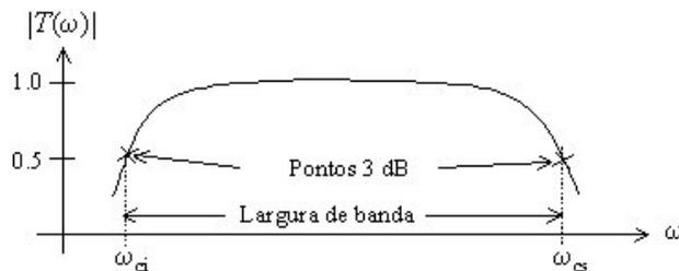
Fig. 6: Resposta espectral de um circuito. Largura de banda. Pontos -3 dB.
