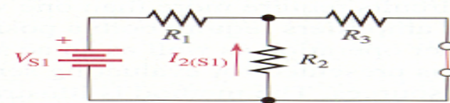
(d) Find I_2 due to V_{S1} : I_{2(S1)} = \left( \frac{R_3}{R_2 + R_3} \right) I_{T(S1)}
